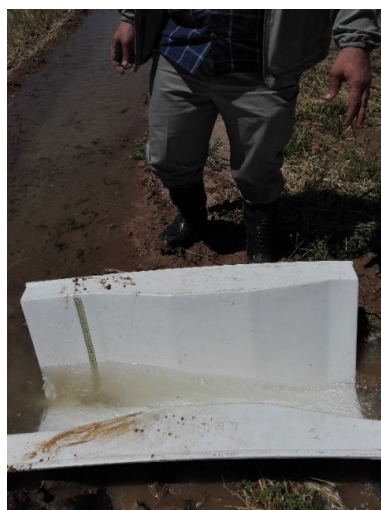
ب) اندازه‌گیری حجم آب ورودی به مزرعه در روش آبیاری سطحی
