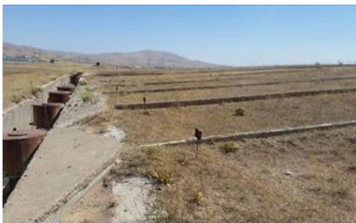
شکل ۳- کرت آزمایشی همراه مخزن جمع‌آوری رواناب- رسوب
