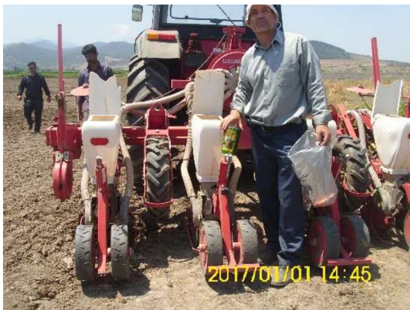
شکل ۱- ردیفکار پنوماتیک کشت دو ردیفه و عملیات زراعی در آزادشهر
